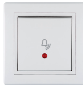
610I.xxx Klingeltastenschalter mit Anzeige 10AX/250V~ • Die Anzeige schaltet sich ein, wenn der Schalter ausgeschaltet ist.
